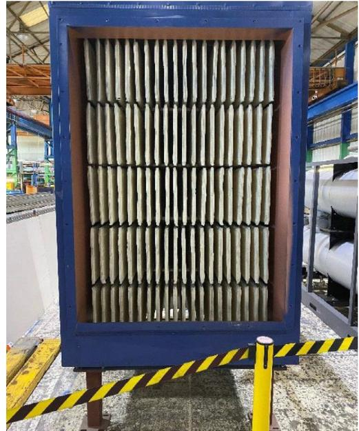
Traitement et filtration absorberont le mercure, les dioxines, les furanes et réduiront la concentration de gaz acides tels que le  $\text{SO}^2$  et en particulier le HF et le HCl.
