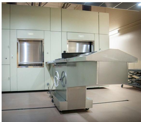
commande manuelle permet de terminer l'introduction si une coupure de courant survient. Le moto-réducteur entraîne une chaîne sur laquelle est fixé le poussoir. Des détecteurs de position (de type inductif) contrôlent les déplacements du poussoir. L'opération est synchronisée avec l'ouverture de la porte du four. Le cycle complet de chargement s'opère en environ 15 secondes.
