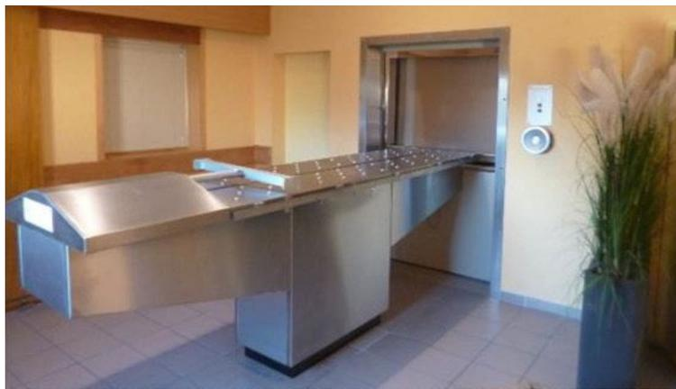
Le catafalque traditionnel est translaté jusqu'au dispositif d'introduction ; le dispositif s'abaisse au niveau du catafalque ;
